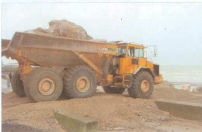
▲ D'énormes camions-bennes munis de vérins hydrauliques assurent des dizaines et des dizaines de rotations par jour, ils passent sur les parapets grâce à des galets...
